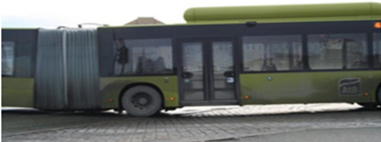
Bilde 3 – Bybusser er sårbare for store endringer i horisontalkurvatur slik fartsdumper er. Bildet er fra Trondheim der belg på leddbuss subber bakken. (foto: Frode Krokstad AtB)
