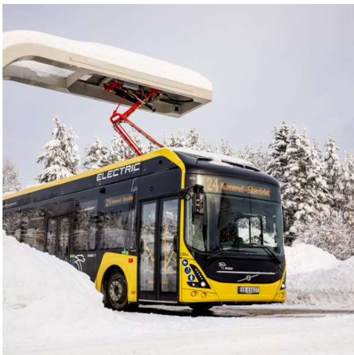
Figur 1-1: Lading ved pantograf for en av Brakars elbusser. Kilde: Brakar.
