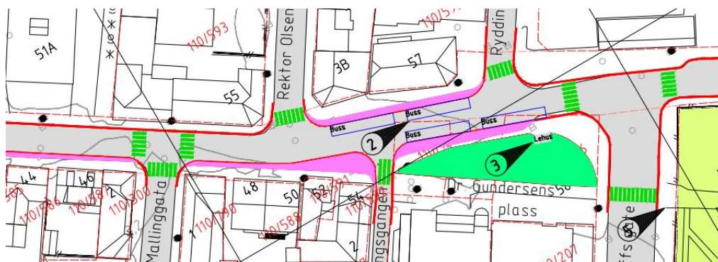
Figur 31 Utvidelse av fortau og opprusting av holdeplassen Knoffs gate. (kilde: Statens vegvesen, 2011)
