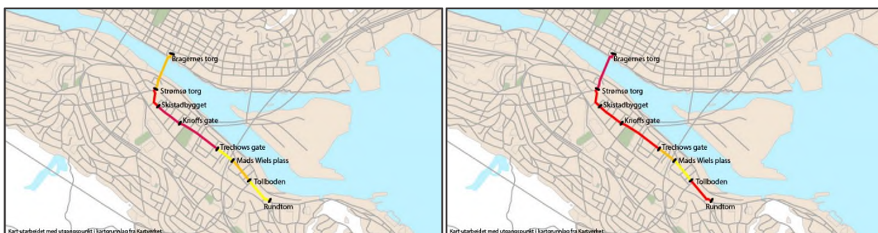
Figur S.4: Gjennomsnittlige bussforsinkelser (sekunder per 1000 meter) om morgenen på strekningen Drammen sentrum – Tordenskiolds gate (Rundtom) i retning mot sentrum om morgenen (til venstre) og i retning fra sentrum om ettermiddagen (til høyre).
