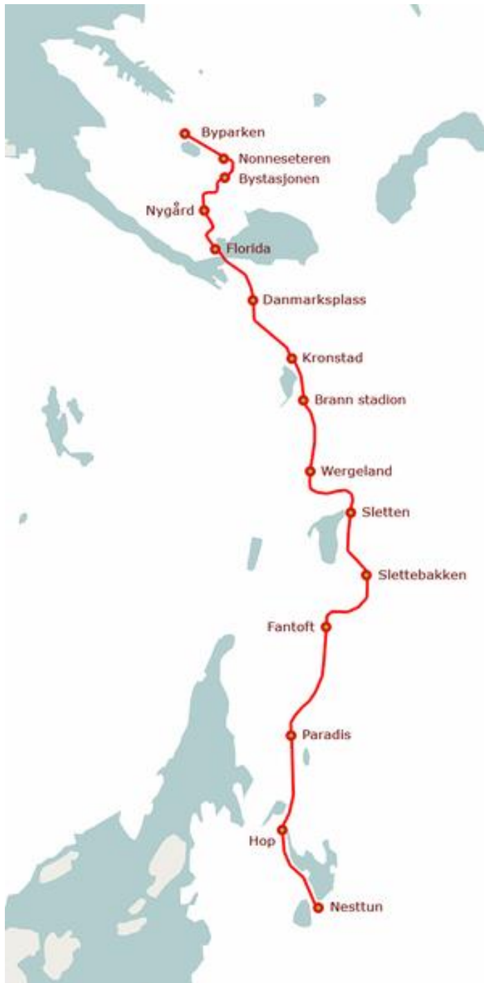
Figur 3-6. Første byggetrinn for Bybanen i Bergen, med 15 holdeplasser og samlet trasélengde på ca. 10 km.
